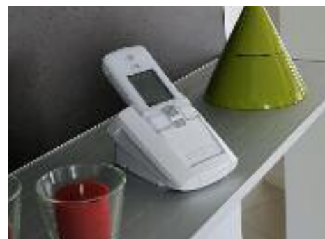
Poste intérieur support secteur base posée sur un meuble
