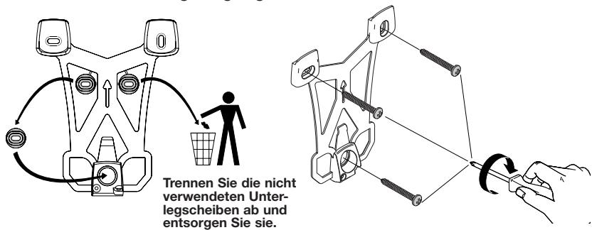
4. Nehmen Sie die Bohrschablonen für den Sabotageschutz-Magneten aus dem Zubehörbeutel und platzieren Sie sie auf der Wandhalterung.
